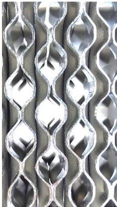
geleitet werden müssen, ist der erzeugte Druckverlust im Kondensator sehr wichtig damit der nachgeschaltete Ventilator keine überhöhten Betriebskosten erzeugt. Das durch die Teilkondensation anfallende Kondensat kann durch die nicht durchgehende Rohrprägestruktur nach unten ungehindert abfließen. Somit tritt beim Hybrid Tubular Plattenwärmetauscher kein Verschluss des Strömungskanals durch das Kondensat auf.
